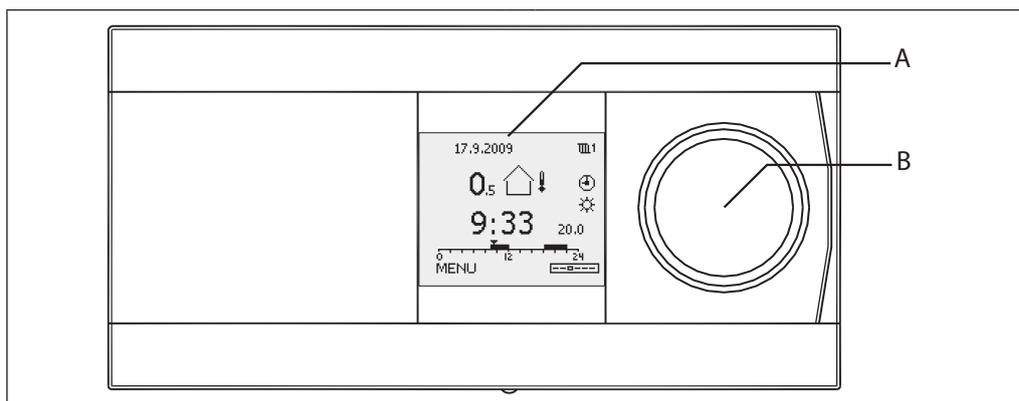
L'écran graphique monochrome (A) indique les valeurs de température, ainsi que les informations d'état, et sert au réglage des paramètres de commande. L'écran est rétroéclairé. Plusieurs écrans favoris peuvent être sélectionnés. La navigation et la sélection des éléments dans les menus s'effectuent au moyen du bouton multifonction (B).
